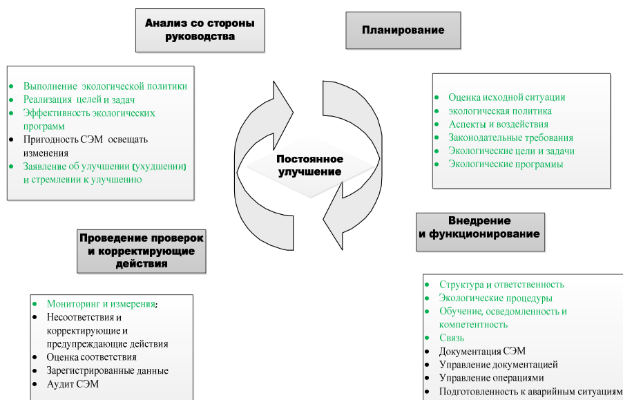
Рис. 1. Модель внедрения СЭМ (по ISO 14001:2004)
